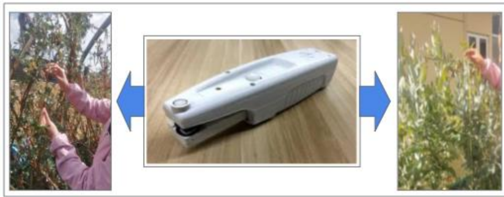
Figura 2. Toma de muestras fotónicas en Polylepis racemosa y Eucalyptus sp. utilizando el dispositivo MultispeQ en condiciones ambientales de la provincia de Huancayo.
